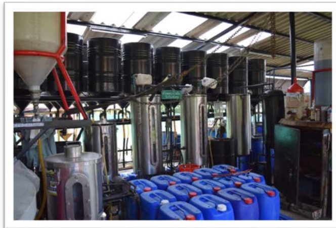
กระบวนการกลั่นน้ำมันพืชใช้แล้วไปสู่การทำน้ำมันไบโอดีเซล B 100 ของกลุ่มวิสาหกิจชุมชนยะลาไบโอดีเซล
